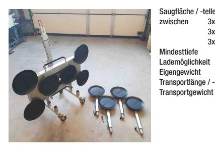
Saugfläche / -teller variabel zwischen 3x2 (450kg) 1300 x 800 mm 3x2+2 (600kg) 2500 x 980 mm 3x2+4 (750kg) 2250 x 1400 mm Mindesttiefe 190 mm Lademöglichkeit 230V Eigengewicht 55 - 80 kg Transportlänge / -breite / -höhe 1,30 / 0,59 / 0,49 cm
